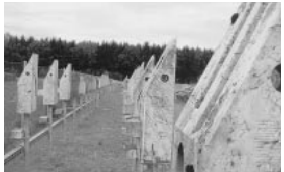
写真5 コンクリートや石材の耐候性試験が長期にわたり続けられている
