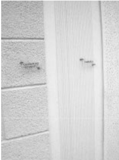
写真11 密着式外断熱仕上材料の耐候性試験
