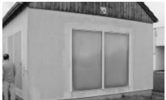
写真6 屋外試験室（透明断熱材の試験）
