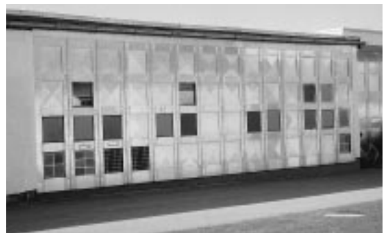
写真10 各種表面仕上材料の耐候性試験
