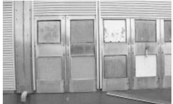
写真9 各種外断熱表面仕上材料の耐候性試験
