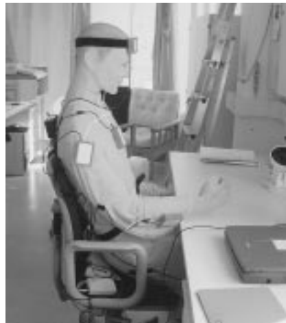
写真1 サーマルマネキンによる実験
