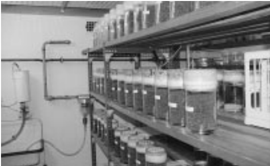
写真7 カップ法による水蒸気拡散抵抗係数 \mu 値測定
