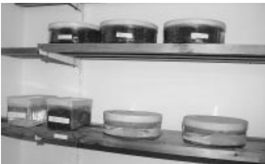
写真8 カップ法による水蒸気拡散抵抗係数 \mu 値測定
